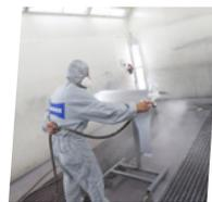
La seconde couche est une couche de base standoblue ou Prélaque Hi-TEC 480. Leur application couvrante et leur précision colorimétrique sont excellents. Ces bases vont également sécher rapidement à seulement 40°C.
